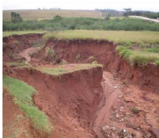
**Figura 52** – Processo Erosivo (Voçoroca) Córrego Baile
